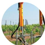
**Contrôle hauteur tête extérieure par vérin hydraulique**
